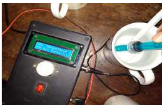
Gambar 15. Hasil pengujian sensor pH pada larutan basa
