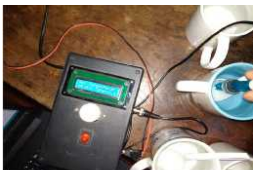
Gambar 13. Hasil pengujian sensor pH pada larutan asam
