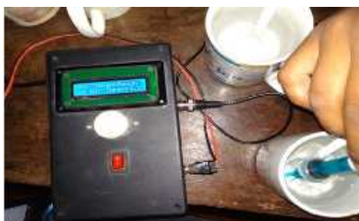
Gambar 14. Hasil pengujian sensor pH pada larutan netral
