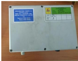
Gambar 2. Pembangkit sinyal Grouser
