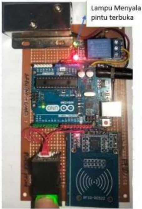
Gambar 6. Pengujian sistem dengan Fingerprint Data hasil pegujian ditunjukkan pada tabel di bawah ini.
