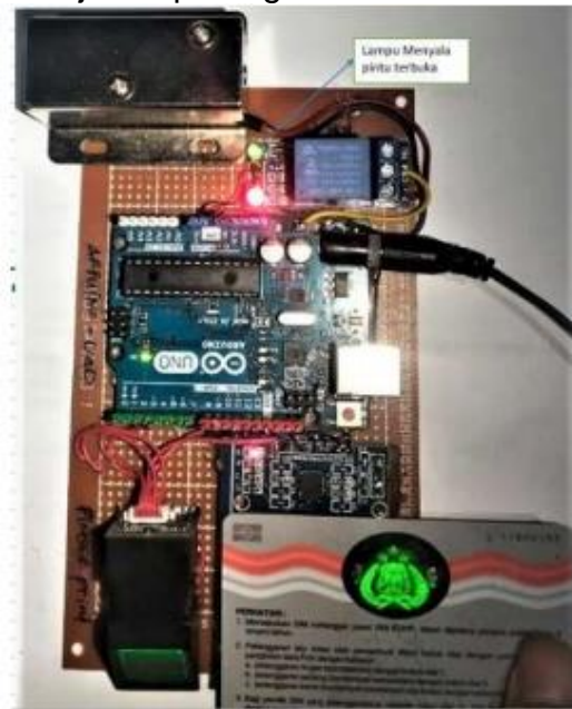
Gambar 5. Pengujian sistem dengan menggunakan RFID
