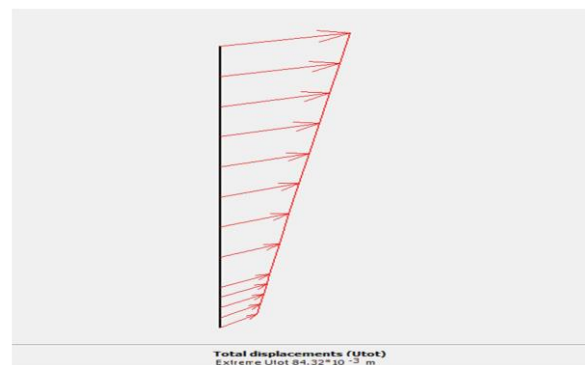
Gambar 3.6 Deformasi tiang sheet pile kondisi efektif stress.
