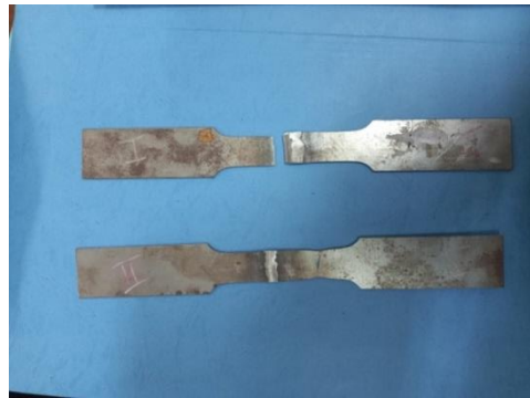
Gambar 4. 8 Hasil Patahan Spesimen uji tarik
