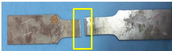
Gambar 4. 10 Spesimen 1 setelah uji tarik
