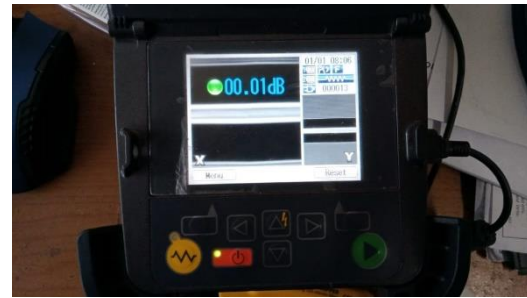
Gambar 7. Hasil splicer ke-7
