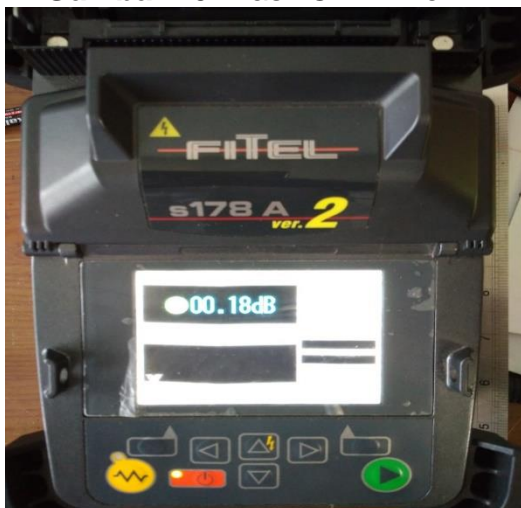
Gambar 11. Hasil splicer ke-15
