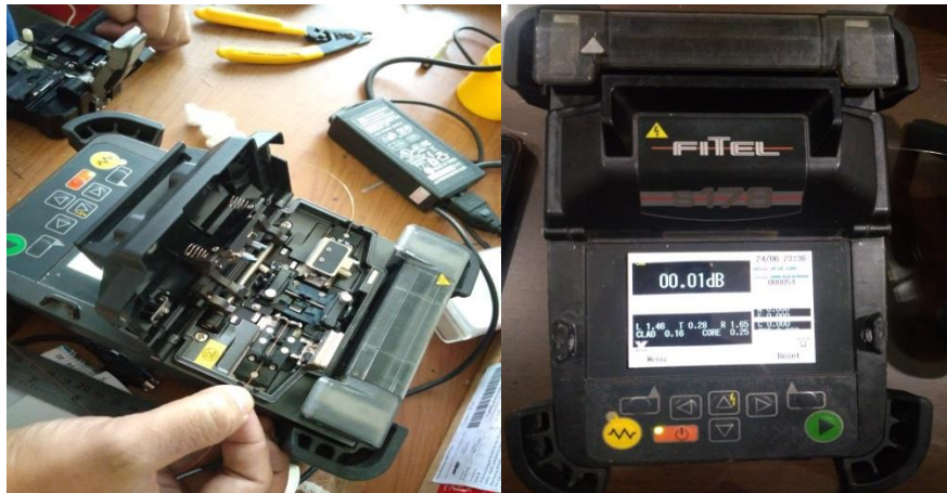
Gambar 6. Proses penyambungan serat optik
