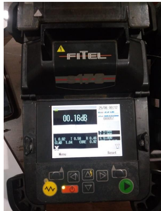
Gambar 9. Hasil splicer ke-14
