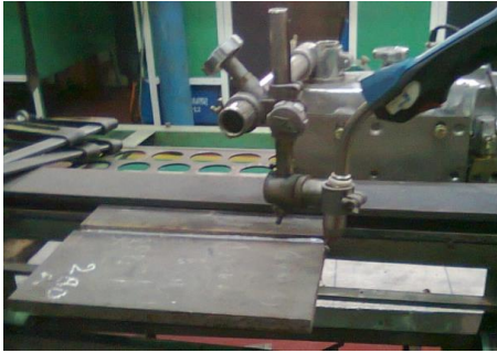
Gambar 2.2 Foto modifikasi pengelasan dengan mesin potong api.
