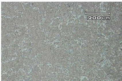
Gambar 3.8 Foto struktur mikro logam lasan pd pengelasan dgn arus 100 A
