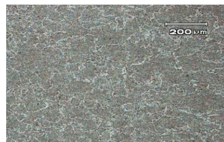
Gambar 3.10 Foto struktur mikro logam lasan pd pengelasan dgn arus 280 A
