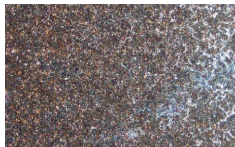
Gambar 3.7 Foto struktur mikro HAZ pd pengelasan dgn arus 280 A
